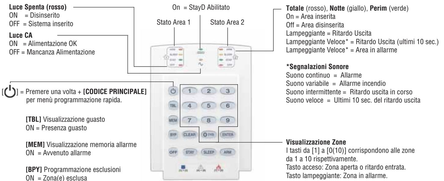
**Figura 2 : MG32LED (Modulo Tastiera a 32 zone)**
